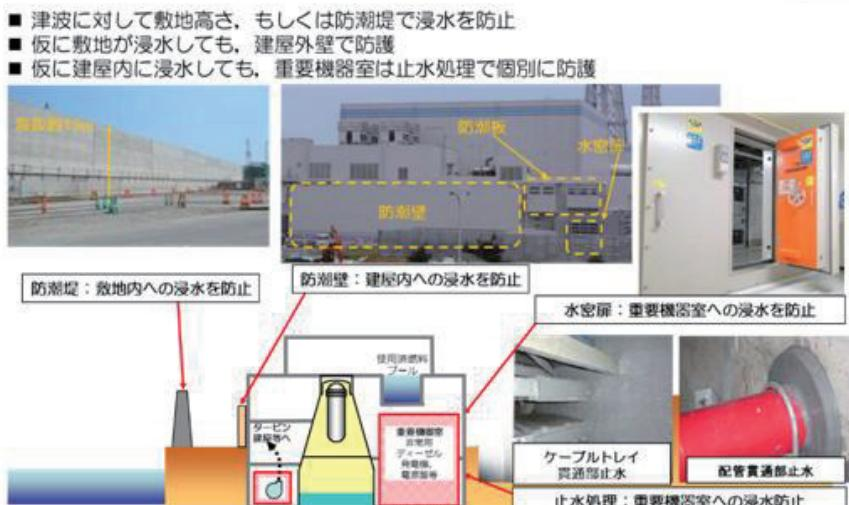
図3 柏崎刈羽発電所の津波防護対策
