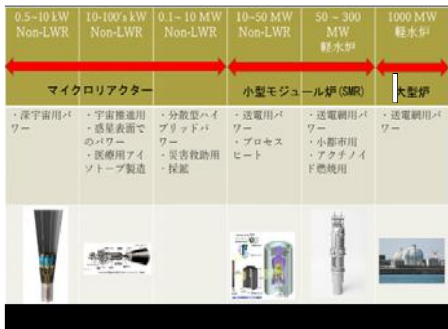
図1 原子炉のサイズの定義（SEJ だより第12号から;筆者作成）
